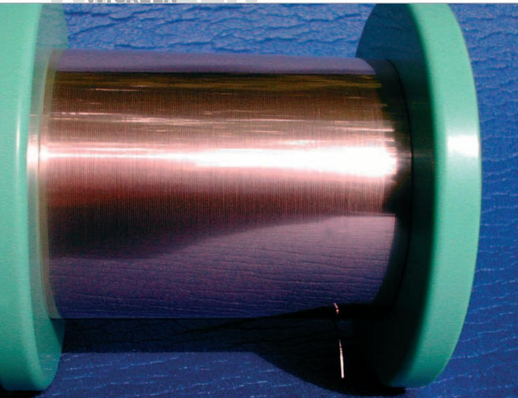
Der Verlegerechner erzeugt mit dem Wickelgut eine fast spiegelgleiche Oberfläche.
